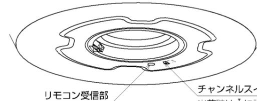
出荷時はⅠに設定されています。器具施工時に変更されている場合があります。「3チャンネルの設定について」をご確認ください。
