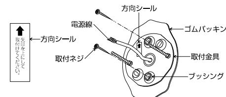
ストリップゲージに合わせて電源線の被覆をむき、接続端子に確実に差し込む。
