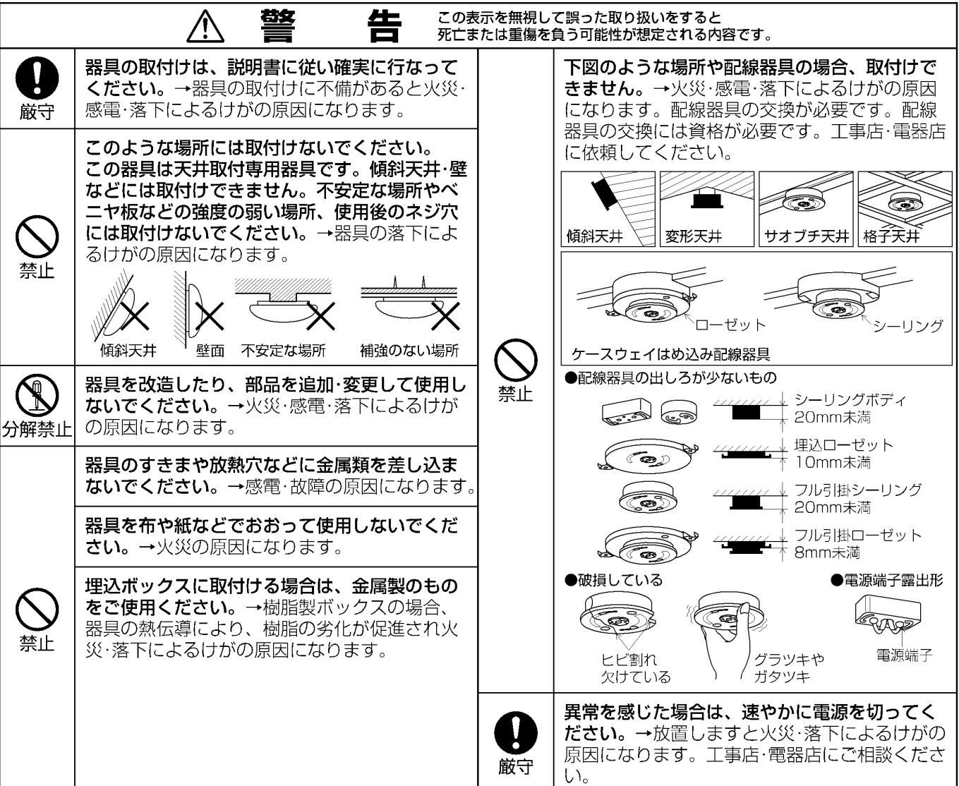
下図のような場所や配線器具の場合、取付けできません。→火災・感電・落下によるけがの原因になります。配線器具の交換が必要です。配線器具の交換には資格が必要です。工事店・電器店に依頼してください。
