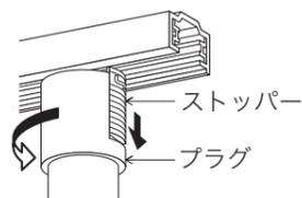
△ 警告 プラグのストッパーを操作する際は慎重に行なってください。プラグが損傷しますと火災・落下によるけがの原因になります。
