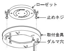
取付金具の矢印(tS)を止めねじに合わせて締め
