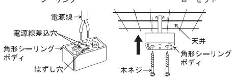
■取付手順 △注意 取付けの際は必ず電源を切ってください。感電の原因になります。
