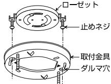
取付金具の矢印(t s)を止めねじに合わせて締め付ける。
