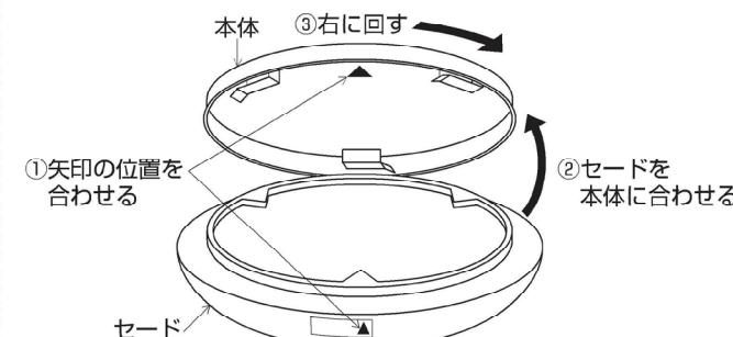
△警告 セードが確実に取付いたことを確認してください。取付けが不完全な場合、落下によるけがの原因になります。
