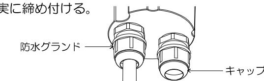
※器具内にキャブタイヤケーブルの外被が出ている状態でキャップを確実に締め付けてください。
