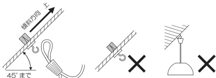
⚠ 警告 ベニヤ板などの強度の弱い場所には取付けないでください。落下によるけがの原因になります。
