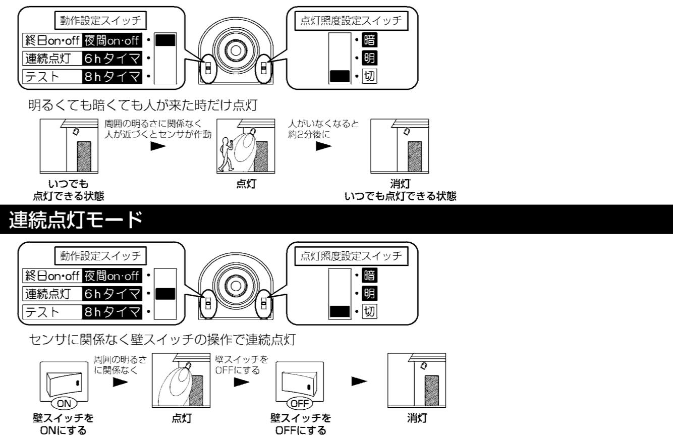
※電源投入後、約50秒間点灯し、その後センサ待機モードになります。人を感知するごとに点灯時間が延長しますが、電源投入から約60秒後に一旦消灯し、センサ待機モードになります。(連続点灯モードを除く。)
