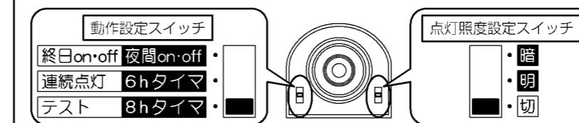
①電源投入後、約50秒間点灯し、その後テストモードになります。
