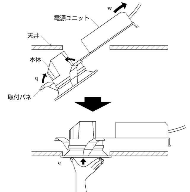
※天井材厚が薄い場合、天井との間に隙間が空くことがありますので、この場合は一度バネを押し広げてから埋込穴に挿入してください。
