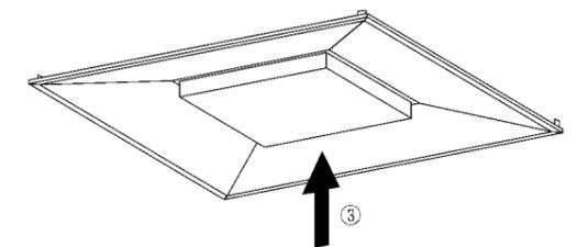
※片側の固定バネのみでLEDユニットが引き上げられた状態ではLEDユニットを正常に取付けられません。片側の固定バネのみでLEDユニットが引き上げられた状態となっている場合は、LEDユニットを一度引き下げてから再度LEDユニットを押し上げてください。
