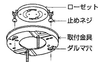
取付金具の矢印(▶◀)を止めネジに合わせて締め付ける。
