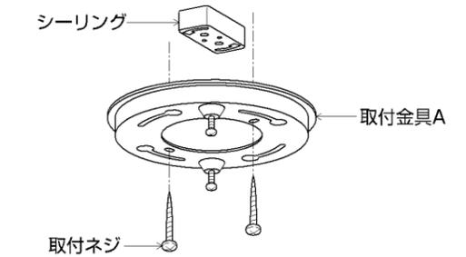
※取付金具Aを取付ける方向により、本体(スライドコンセント)の方向が決まります。
