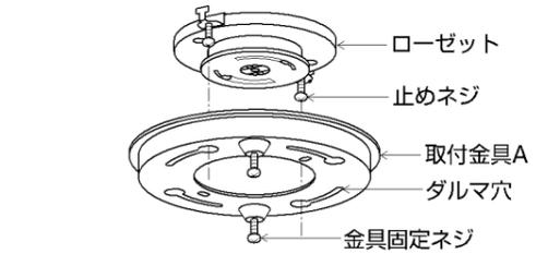
取付金具Aを回転させ、止めネジを締め付けて取付ける。
