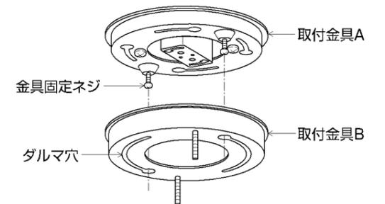
取付金具Bを回転させ、金具固定ネジで締め付けて取付ける。
