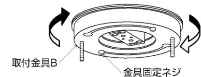
※取付金具Bの取付位置により、本体(スライドコンセント)の方向を約90°調整できます。
