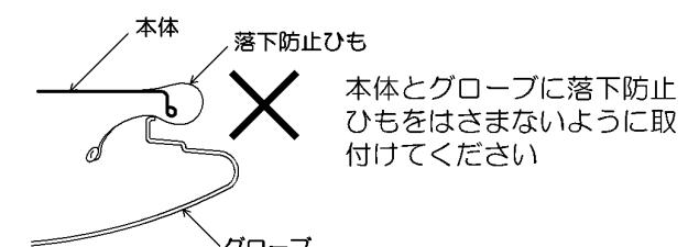
△警告 グローブが確実に取付いたことを確認してください。取付けが不完全な場合、落下によるけがの原因になります。
