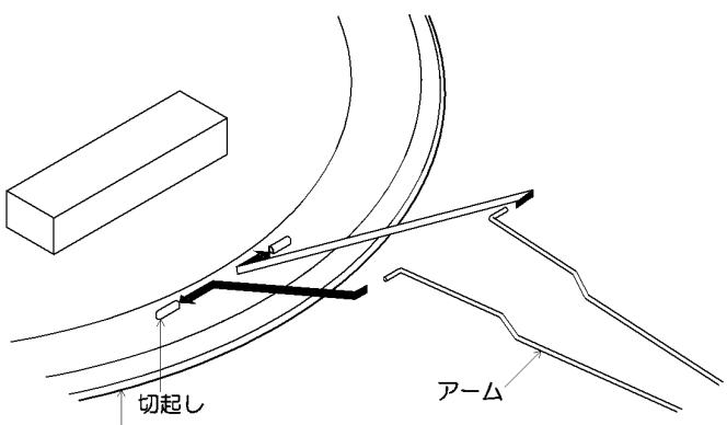
△警告 アームは下図の向きで取付けてください。間違えて取付けた場合、布セードの落下の原因になります。
