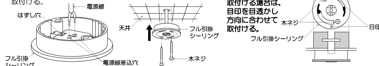
\*目透かし天井に取付ける場合は、目印を目透かし方向に合わせて取付ける。
