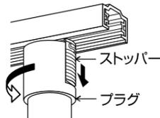
△警告 プラグのストッパーを操作する際は慎重に行ってください。プラグが損傷すると火災・落下によるけがの原因になります。
