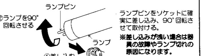
ランプピンをソケットに確実に差し込み、90°回転させて取付ける。
