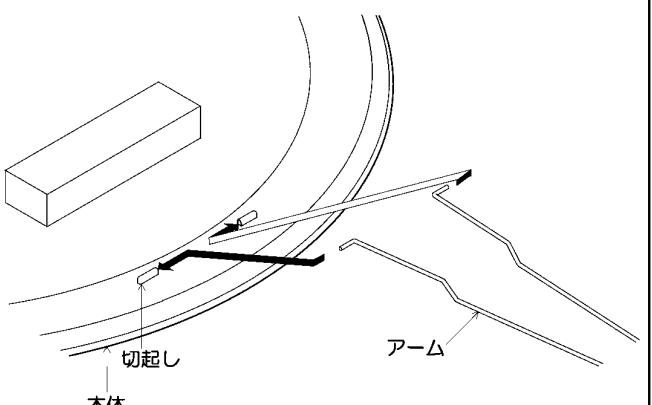
△警告 アームは下図の向きで取付けてください。間違えて取付けた場合、布セードの落下の原因になります。
