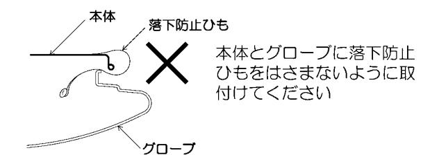
△警告 グローブが確実に取付いたことを確認してください。取付けが不完全な場合、落下によるけがの原因になります。
