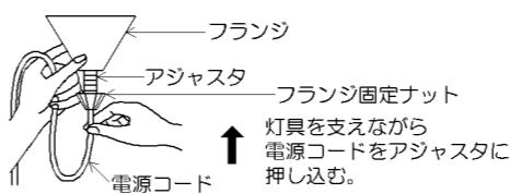
※電源コードの調整が固い場合は、一旦、フランジ固定ナットをアジャスタから取り外し、もう一度2回転程締め付け、仮止めしてください。
