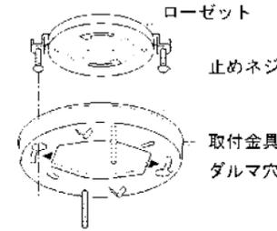
取付金具の矢印 (ts) を止めネジに合わせて締め付ける。
