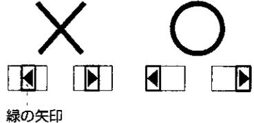
△警告 緑の先端が両端にくるまで本体を押し上げてください。取付けが不完全な場合、落下によるけがの原因になります。
