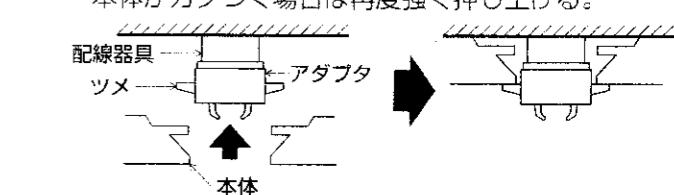
\*本体を取付けた後、本体が安定しないときは、ノックアウト穴を利用し、取付ネジ(市販品)で止めます。
