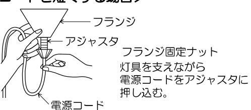
※電源コードの調整が固い場合は、一旦、フランジ固定ナットをアジャスタから取外し、もう一度回転して締め付けてください。
