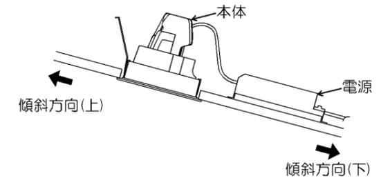
※天井材厚が薄い場合、天井との間に隙間が空くことがありますので、この場合は一度パネを押し広げてから埋込穴に挿入してください。
