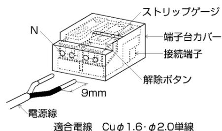
△警告 電源の接続は確実に行ってください。端子台カバーを外さずに電源線を接続してください。接続が不完全な場合や電源線が器具に接触した場合、容量オーバーした場合は火災・感電の原因になります。
