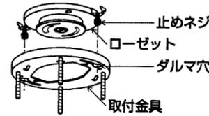
取付金具の矢印(◀▶)を止めネジに合わせて締め付ける。
