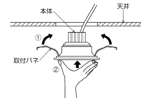
※天井材厚が薄い場合、天井との間にすきまが空くことがありますので、この場合は一度バネを押し広げてから埋込穴に挿入してください。
