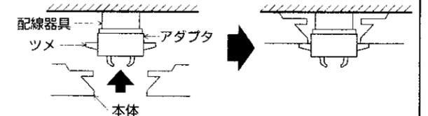
※本体を取付けた後、本体が安定しないときは、ノックアウト穴を利用し、取付ネジ(市販品)で止める。
