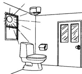
トイレ・浴室一体のユニットバスなど、蒸気や熱気が直接センサに入る場所には取付けないでください。
