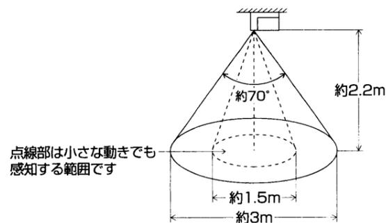
・器具取付け位置によってはドアの位置や開閉方向により感知しにくくなる場合があります。感知しにくい場合は、本体の取付方向を変えてセンサの位置を調整してください。
