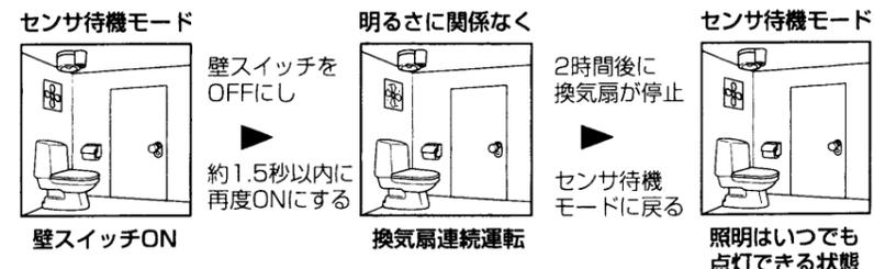
■モードの切り替えを壁スイッチで操作する (プルレス操作)
