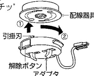
△警告 解除ボタンを押さずに左に回し、はずれないことを確認してください。アダプタの取付けが不完全な場合、落下によるけがの原因になります。
