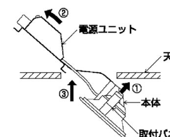
※天井材厚が薄い場合、天井との間にすきまが空くことがありますので、この場合は一度パネを押し広げてから埋込穴に挿入してください。
