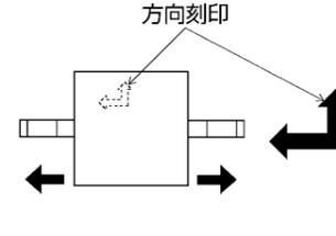
△警告 方向刻印に従って取付けてください。指定方向以外に取付けた場合は火災の原因になります。
