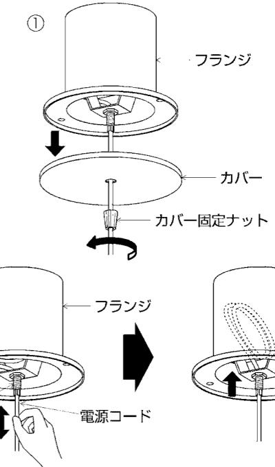
②電源コードをアジャスターに押し込み、横から引き出して長さを調整する。押し込んだ電源コードをフランジ内に収納する。
