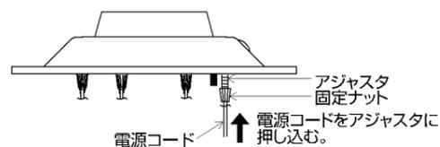
※電源コードの調整が固い場合は、一旦、固定ナットをアジャスタから取外し、もう一度2回転程締め付け、仮止めしてください。
