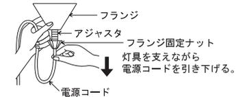
※電源コードの調整が固い場合は、一旦、フランジ固定ナットをアジャスタから取外し、もう一度2回転程締め付け、仮止めしてください。
