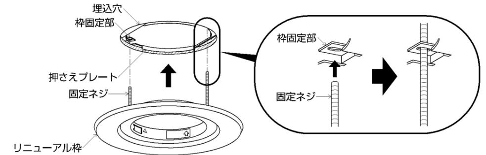
②リニューアル枠の固定ネジにローレットナットを締め付けて確実に固定する。
