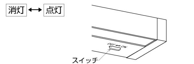
※壁スイッチのある場合、あらかじめ壁スイッチをONにし、スイッチを操作してください。
