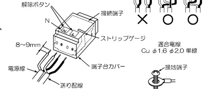
△警告 防雨・防湿型で取付ける場合は、D種(第三種)接地工事を行ってください。接地工事が不完全な場合、感電の原因になります。
