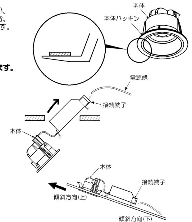
※天井材厚が薄い場合、天井との間に隙間が空くことがありますので、この場合は一度パネを押し上げてから埋込穴に挿入してください。
