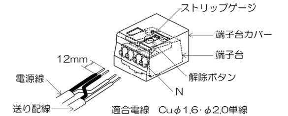
△警告 電源の接続は確実に行ってください。端子台カバーを外さずに電源線を接続してください。接続が不完全な場合や電源線が器具に接触した場合、容量オーバーした場合は火災・感電の原因になります。
