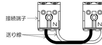
ストリップゲージに合わせて電源線の被覆をむき、端子台カバーの上から端子台に確実に差し込む。このとき、電源線は器具から離して施工する。また、送り配線は照明器具専用とする。(最大送り容量6A以下) 外す時は解除ボタンを押しながら、電源線を抜く。但し、無理な力を加えないでください。端子台が破損します。
