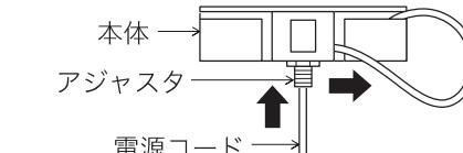
②押し込んだ電源コードを本体側面で束ね、コード押さえ(コード押さえ)に引っ掛ける。
